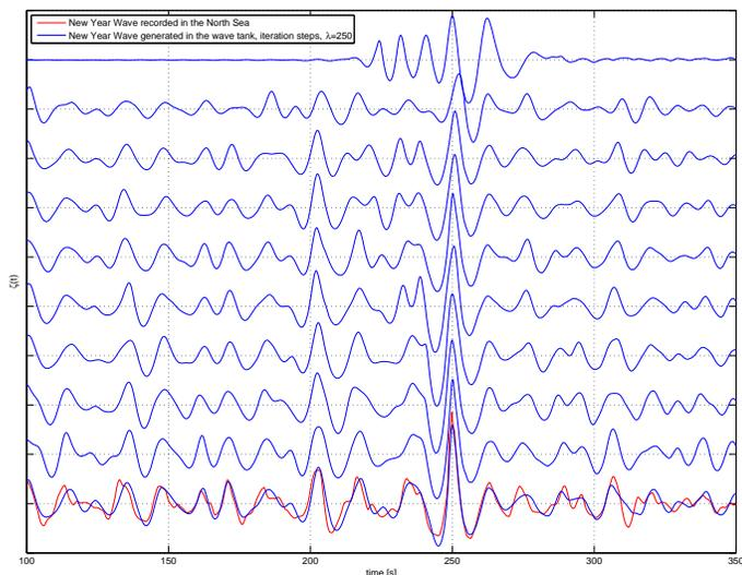
Figure 6. OPTIMIZATION OF WAVE TRAIN BY SEVERAL ITERATION STEPS STARTING FROM A CONTROL SIGNAL FOR A WAVE PACKET. (WAVE TANK SIMULATION AT SCALE 1:250, PRESENTED AS FULL SCALE DATA).
