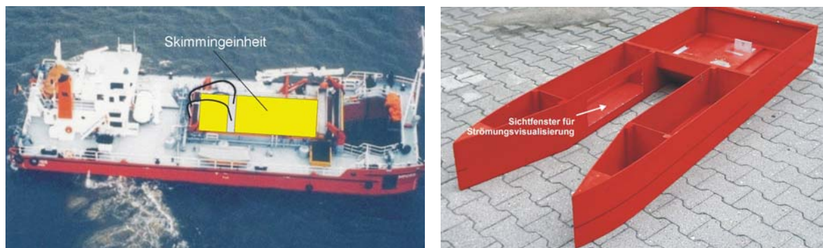
Abb. 6: Schematische Darstellung des MPOSS Schiffs mit integriertem Ölskimmer (links), Ansicht des Trägerschiffmodells (rechts)
